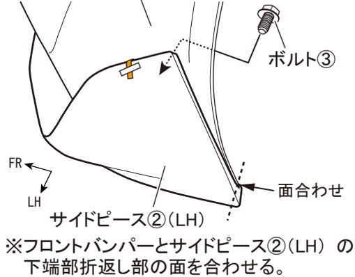
2. 図 18 のように取付け位置を確認して両面テープの離型紙を矢印の方向へ番号順に剥がしながら貼付け圧着する。
