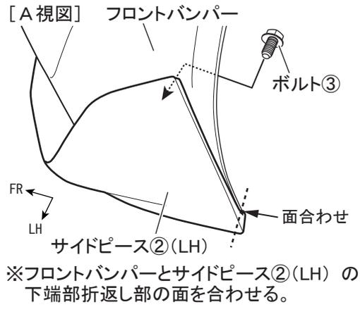
図 13 ※LH図示 左右共通作業
