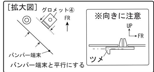
17. 図12のようにセンターピース①、サイドピース②をフロントバンパーの形状に合わせて押し当てながら位置決めし、下面をクリップ⑦または車両ボルト、タッピングスクリューA④、タッピングスクリューB⑤で仮締めし、側面をフロントフェンダーライナーをめくりボルト③で仮締める。
