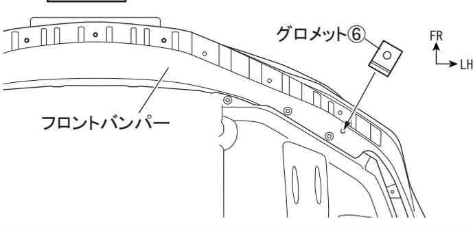
16. 図11のようにフロントバンパー下面のφ10.0に合わせてグロメット⑥を取付ける。(左右各1箇所)
