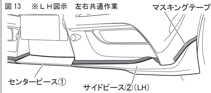
18. 図 13 のようにセンターピース①、サイドピース②の端末に合わせてフロントバンパーの図示部にマスキングテープを貼付ける。
