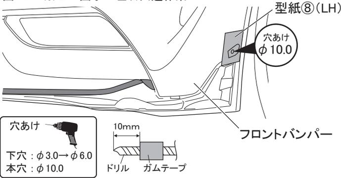
14. 図10のようにフロントバンパー側面の型紙⑧の穴あけ位置に合わせて下穴をφ3.0→φ6.0の順であけ、φ10.0の本穴をあける。(左右各1箇所)
