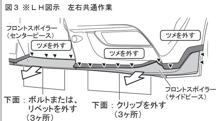
△注意：フロントスポイラー（センターピース）下面は、車両によりボルトまたはリベットで締結されています。ボルト締結の場合は、車両ボルトを再使用しますので破損や紛失がないよう十分に注意して保管してください。また、車両フロントスポイラーを取外す際にロアグリルとのツメ勸合部が破損する場合があります。予めご了承ください。
