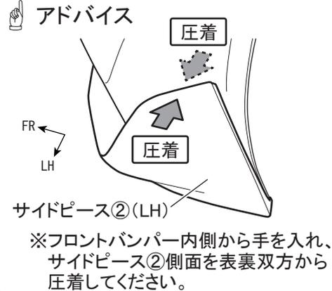
👉 **アドバイス** 両面テープの接着力は安定するまで3～5時間程度必要です。製品の取付け後は、最低3時間程度、強い振動や風圧（車両の移動を含む）が、掛からないようにオープンタイム（静止時間）お取りください。
