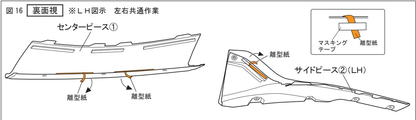
△注意：両面テープの接着力を最大限に発揮させる為、貼付け作業前に両面テープ部及び車両の貼付け部をドライヤー等で約40℃程度に暖めてください。
