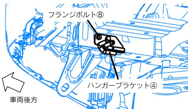
6. 図4のように、リヤサイドメンバーLHにハンガーブラケット④をフランジボルト⑧で仮締めする。
