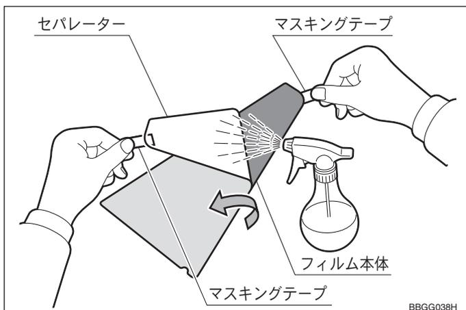
5. マスキングテープを持って、粘着面にたっぷり施工液をスプレーしながら、フィルムからセパレーターを剥がす。
