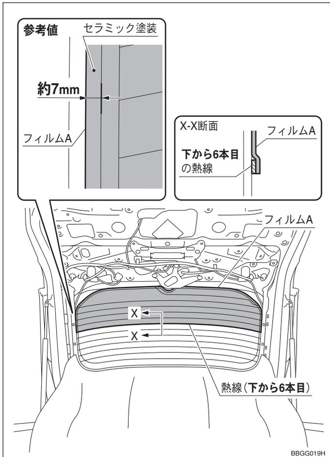
6. 左図 X-X 断面に従い、フィルム A の下端を**下から 6 本目**の熱線下端部に合わせ、バックドアガラスに左右均等に取り付ける。
