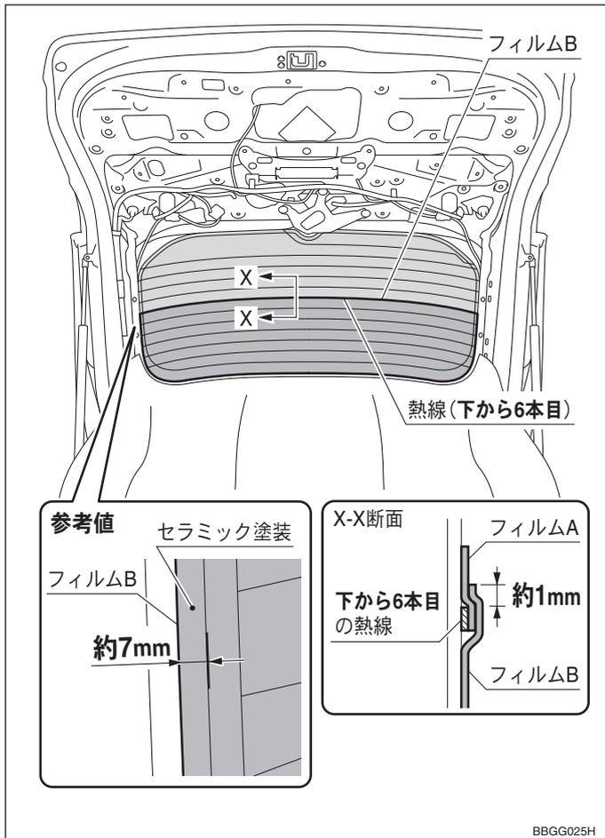
16. 左図 X-X 断面に従い、**下から 6 本目**の熱線上端部からフィルム A と B が**約 1mm** ラップするよう、左右均等に取り付ける。
