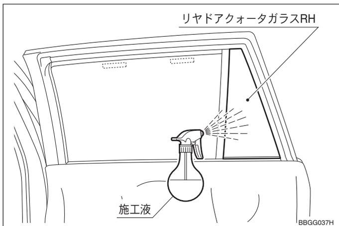
3. リヤドアクォータガラス RH 室内側全面に施工液をたっぷりスプレーし、ガラスを清掃する。
