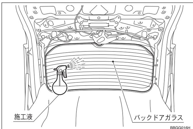
4. バックドアガラス室内側全面に、再度施工液をスプレーする。
