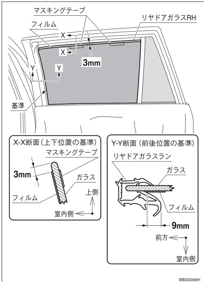
7. ガラス上端からフィルム上端が均等に **3mm** (左図 X-X 断面) の位置になるように取り付ける。
