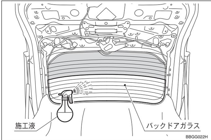
13. 取り付けしたフィルム A より下のバックドアガラス室内側全面に施工液をたっぷりスプレーし、ガラスを清掃する。
