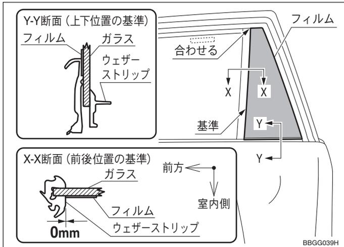
6. 前後の基準となるフィルム前端部 (左図 X-X 断面) とウェザーストリップ端部との間隔を均等に **0mm** に保ち、フィルム前端角部をウェザーストリップ前方上端に接するまでスライドさせ、フィルム下端部 (左図 Y-Y 断面) をウェザーストリップ内側に押し込んで取り付ける。
