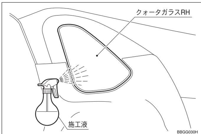
3. コータガラス RH 室内側全面に施工液をたっぷりスプレーし、ガラスを清掃する。
