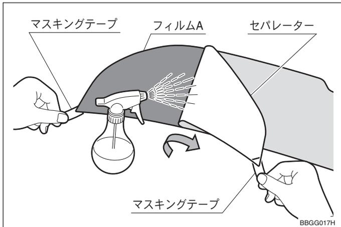
5. マスキングテープを持って、粘着面にたっぷり施工液をスプレーしながら、フィルム A からセパレーターを剥がす。
