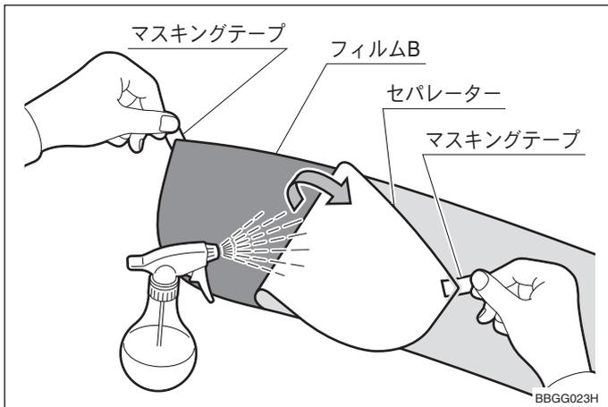
15. マスキングテープを持って、粘着面にたっぷり施工液をスプレーしながら、フィルム B からセパレーターを剥がす。
