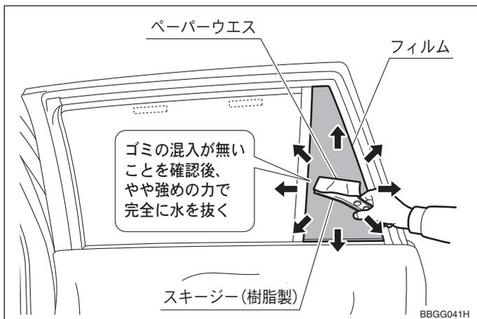
9. ゴミ・ホコリの混入が無いことを確認する。万一混入していた場合は、その部分まで施工液を吹き付けながらフィルムをゆっくり剥がし、異物を除去した後再度取り付ける。
