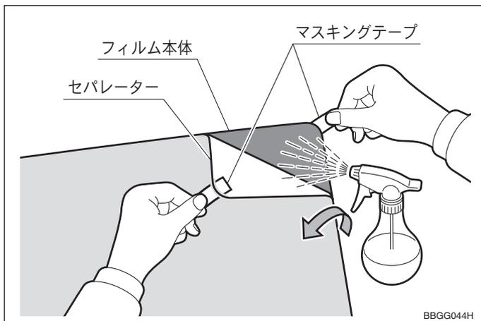
6. マスキングテープを持って、粘着面にたっぷり施工液をスプレーしながら、フィルムからセパレーターを剥がす。
