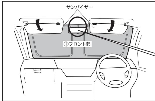
1) マジックテープをはずし、①フロント部をフロントガラス面に取付け、マジックテープを下図のように固定します。
