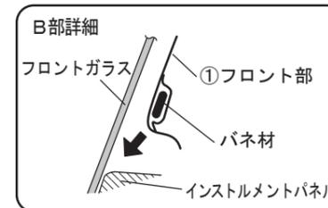
3) サンバイザーを下げ、①フロント部を固定します。
