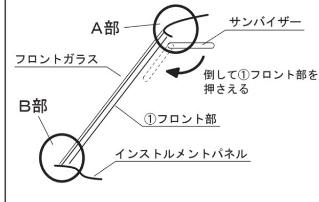
2) ①フロント部上下のパネ材を下図の様に固定します。
