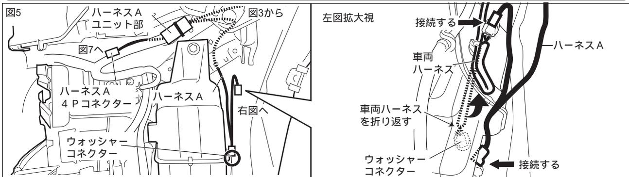
7. 図5のように、ハーネスA をウォッシャータンク側に引廻し、車両配線に沿って配置する。
