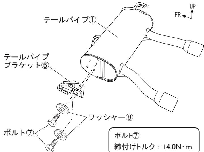
3. 図2のようにエキゾーストパイプ②にテールパイプブラケット⑤をボルト⑦、ワッシャー⑧を使用して指定トルクで取付ける。
