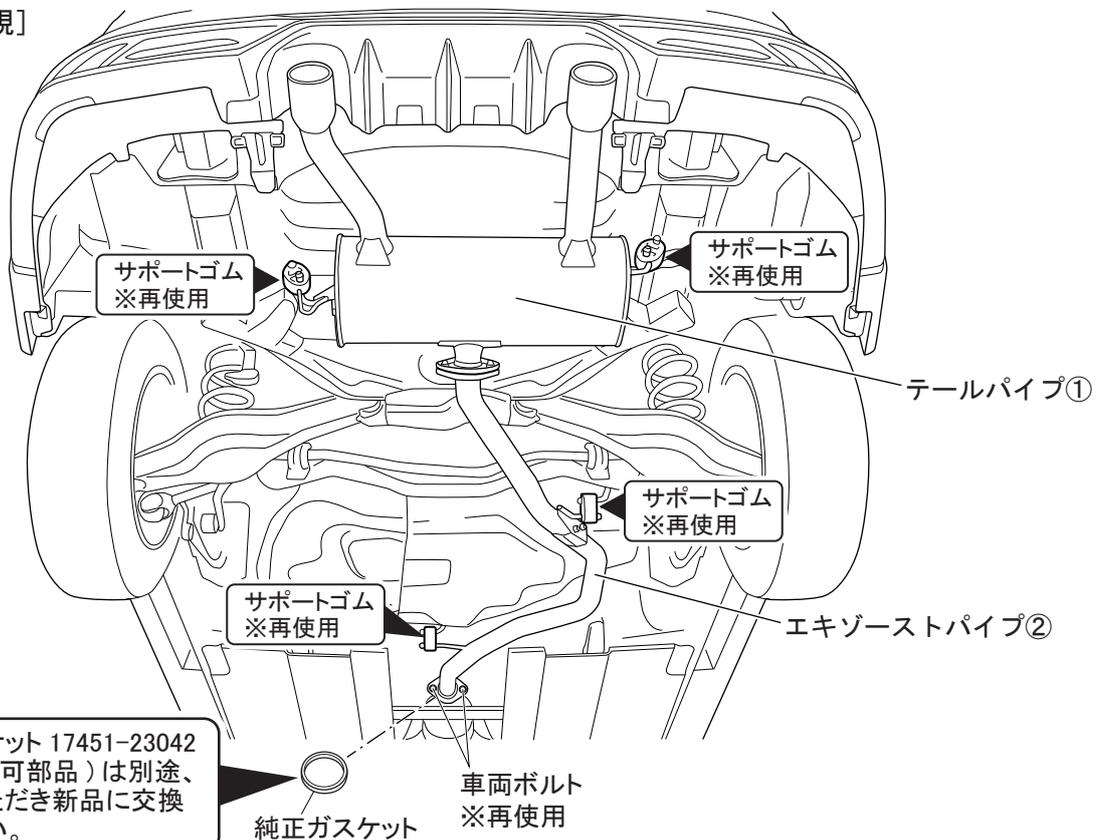
△注意: エキゾーストパイプ②と車両エキゾーストパイプ連結部のガスケットは、必ず新品の純正ガスケット(17451-23042)に交換してください。
