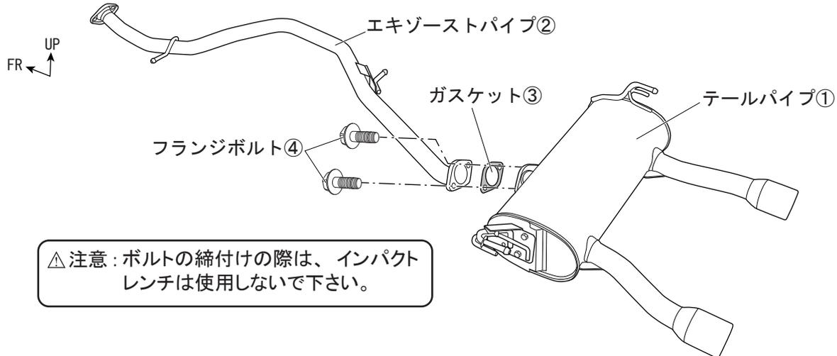
5. 図4のようにテールパイプASSYを車両ボルトおよびサポートゴムを再使用して仮固定する。
