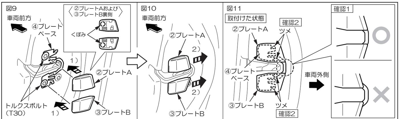
(3) 図9、10、11のように以下の手順に従って④プレートベースに②プレートAおよび③プレートBを取付ける。
