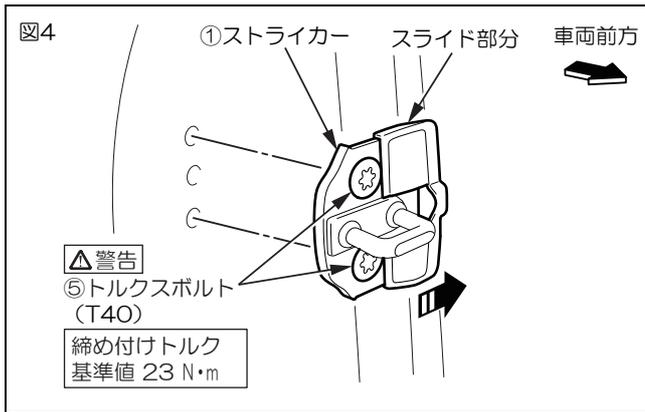
(2) 図4、5のようにスライド部分をスライドさせた状態で、車両に①ストライカーを取付ける。
