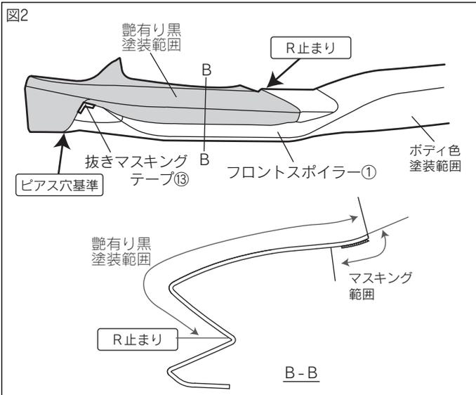
2. 図2のようにフロントスポイラー①を抜きマスキングテープ⑬を使用してマスキングし、艶有りで塗装する。
