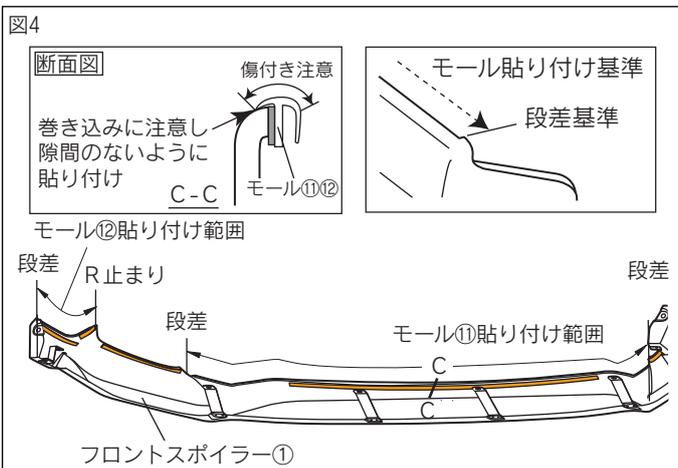
2. 図4のようにフロントスポイラー①に、モール⑪⑫の両面テープの離型紙を剥がしながら貼付け、圧着する。
