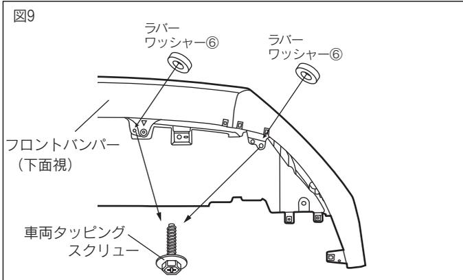
7. 図9のようにフロントバンパーから車両タッピングスクリューを取外す。
