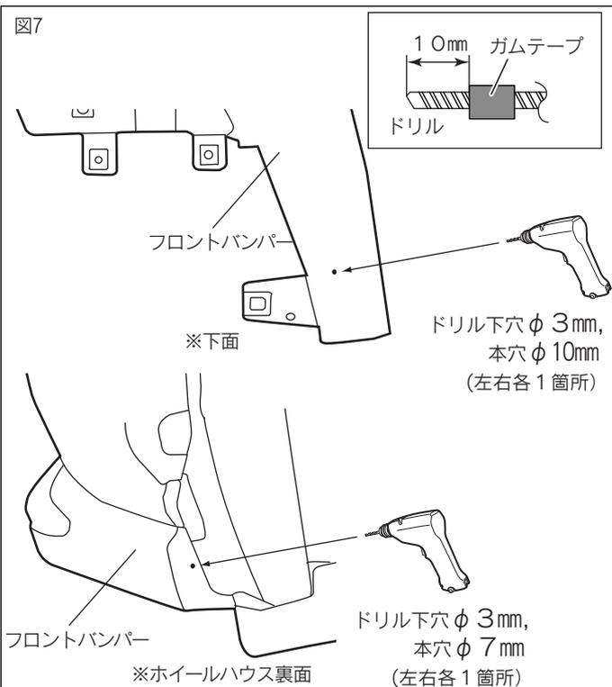
3. 型紙⑨をフロントバンパーから剥がし、図7のようにφ3mm、φ7mm、φ10mmのドリル先端にストッパーとなるよう10mmの位置にガムテープを巻き付け、φ3mmのドリルを使用してフロントバンパー下面・ホイールハウス部のマーキング位置に下穴をあける。
