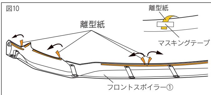
9. フロントスポイラー①の両面テープの離型紙を、図10のように矢印の向きに約30mm剥がし、マスキングテープ等で表側に貼付ける。
