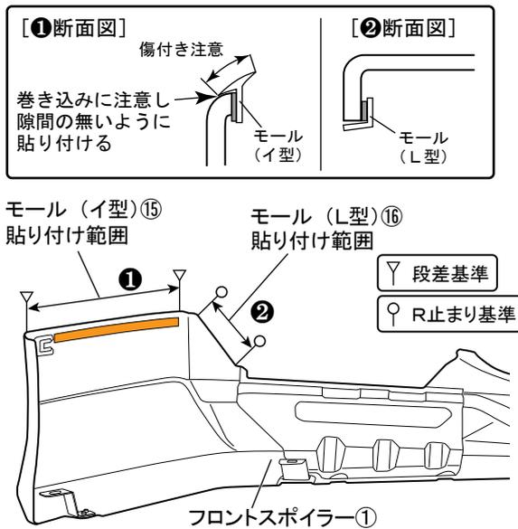
2. 図 49 のようにモール（イ型）⑮、モール（L型）⑯の両面テープの離型紙を剥がしながら、貼り付け圧着する。モール（イ型）⑮、モール（L型）⑯長めに設定されているので、長さを合わせてハサミ等で切り落とす。
