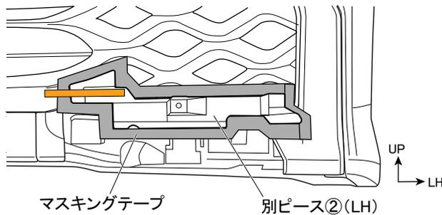
3. 図 26 のように別ピース②周囲端末に合わせてフロントロアグリル部にマスキングテープを貼り付ける。
