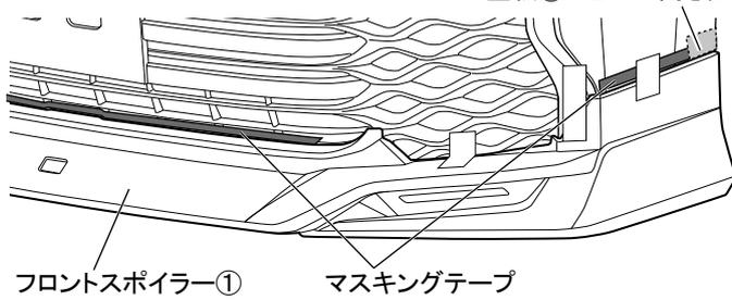
13. 図 35 のようにフロントスポイラー①上端（モール貼り付け部はモール上端）に合わせてフロントバンパーにマスキングテープを貼り付ける。
