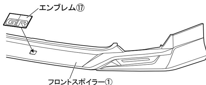
1. 図 50 のようにフロントスポイラー①中央凹部の座面をイソプロピルアルコール（IPA）で一方向に拭いて脱脂し、エンブレム⑰を貼り付け圧着する。
