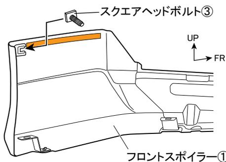
10. 図 32 のようにフロントスポイラー①裏面にスクエアヘッドボルト③を取り付ける。（左右各1箇所）
