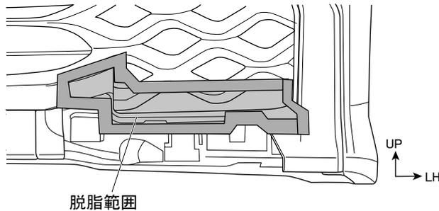
5. 図 27 のように別ピース②の両面テープ貼り付け部の汚れを取り除き、イソプロピルアルコール (IPA) で一方向に拭いて脱脂する。(左右各1箇所)
