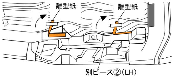
20. 図 40 のように別ピース②の両面テープの離型紙を矢印の方向に約30mm 剥がしてマスキングテープ等でフロントロアグリルに貼付ける。(左右各2箇所)
