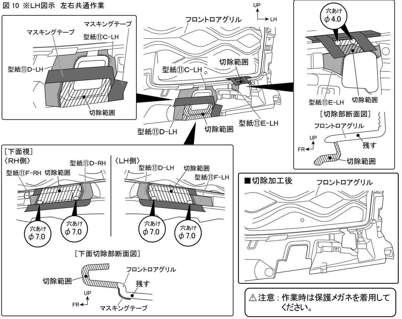
12. 型紙①C、D、E、Fおよびマスキングテープを剥がし、切除部周囲のバリを除去する。
