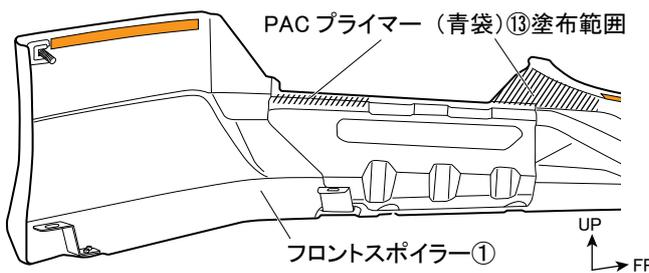
16. 図 37 のようにフロントスポイラー①裏面の別ピース②の両面テープ貼り付け部（左図斜線部）にPACプライマー（青袋）⑬を塗布する。（左右各2箇所）
