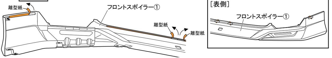
22. 図 42 のようにフロントスポイラー①LEDランプハーネスをフロントロアグリルの開口部からフロントバンパー内側へハーネスの噛み込み等が無いことを確認して引き込み、ハーネスC③のコンネクターと接続する。(左右各1箇所)
