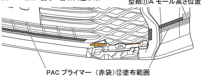
18. 図 39 のようにフロントスポイラー①の両面テープ貼り付け部（左図斜線部）にPACプライマー（赤袋）⑫を塗布する。
