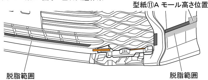
17. 図 38 のようにフロントスポイラー①の両面テープ貼り付け部の汚れを取り除き、イソプロピルアルコール（IPA）で一方向に拭いて脱脂する。
