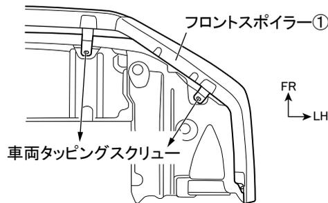
25. 図 44 のようにフロントバンパー下面の車両タッピングスクリューを取り外す。(左右各2箇所)
