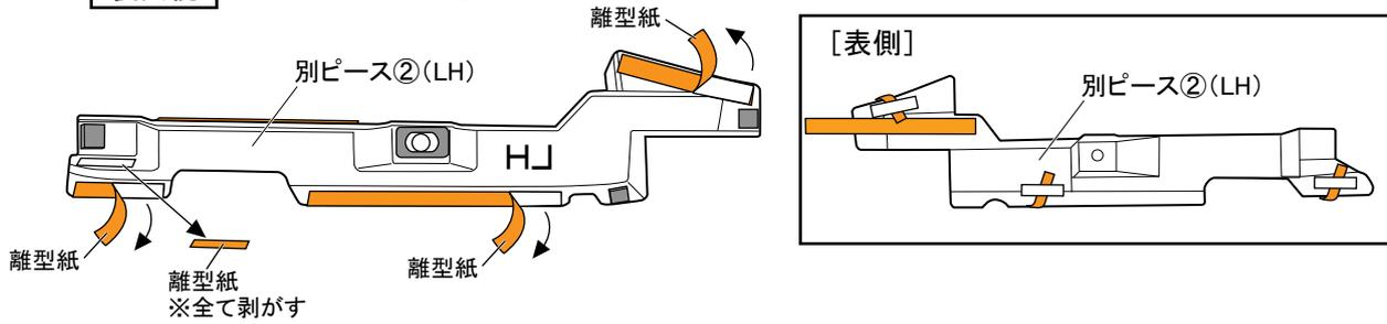
8. 図 30 のようにフロントロアグリル部に別ピース②をあて、クリップB⑥で固定する。（左右各1箇所）
