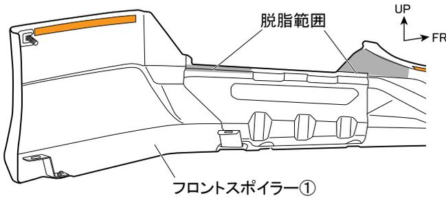
15. 図 36 のようにフロントスポイラー①裏面の別ピース②の両面テープ貼り付け部の汚れを取り除き、イソプロピルアルコール（IPA）で一方向に拭いて脱脂する。（左右各2箇所）
