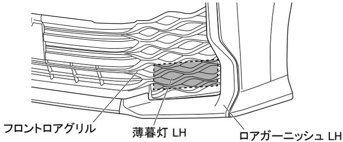
1. 図1のように該当車両の修理書に従い、車両からフロントバンパーを取り外し、フロントバンパーからフロントロアグリル、薄暮灯 (RH/LH)、ロアガーニッシュ (RH/LH) を取り外す。
