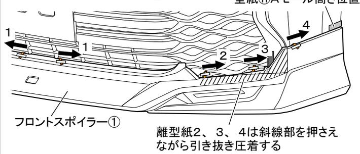
24. 図 43 のように取り付け位置を確認して両面テープの離型紙を矢印の方向へ番号順に剥がしながら貼り付け圧着する。(左右各4箇所)
