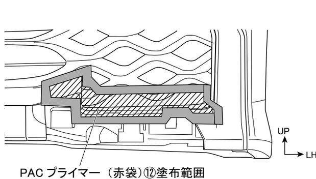
6. 図 28 のように別ピース②の両面テープ貼り付け部 (左図斜線部) にPACプライマー (赤袋)⑫を塗布する。(左右各1箇所)
