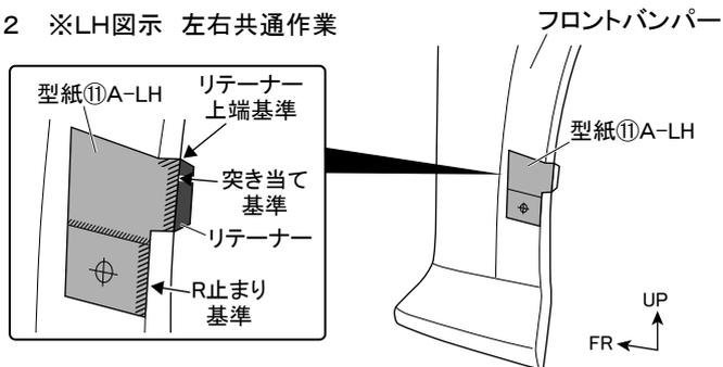
2. 図2のように型紙①Aをフロントバンパー側面に貼り付ける。(左右各1箇所)
