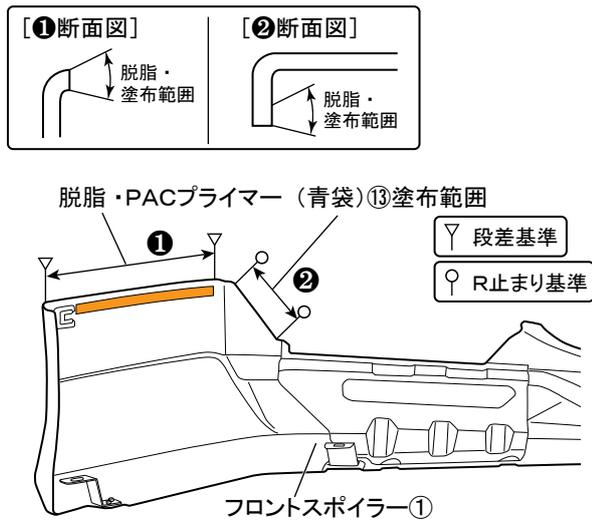
1. 図 48 のようにモール（イ型）⑮、モール（L型）⑯貼り付け部の汚れを取り除き、イソプロピルアルコール（IPA）で一方向に拭いて脱脂し、モール貼付け部のみPACプライマー（青袋）⑬を塗布する。
