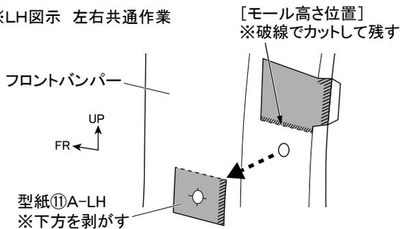
4. 図4のように型紙①Aの破線に沿って切り取り、モール高さ位置を残して下方を剥がし、穴周囲のバリを除去する。(左右各1箇所)
