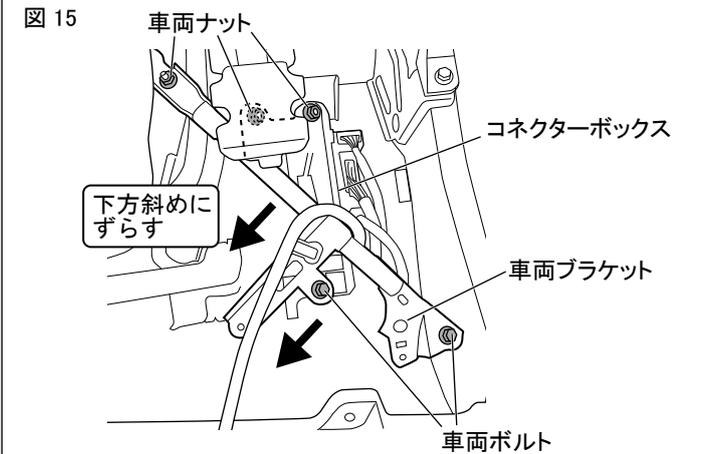
3. 図 15 のように車両ボルト (2箇所)、車両ナット (3箇所) を取り外し、車両ブラケットとコネクターボックスを下方斜め方向にずらす。
