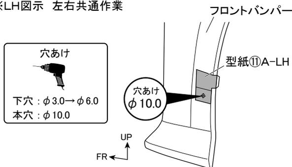
3. 図3のようにフロントバンパーの型紙①Aの穴あけ位置に合わせて下穴をφ3.0→φ6.0の順であけ、φ10.0の本穴をあける。(左右各1箇所)
