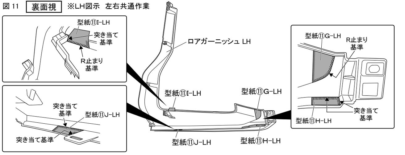
14. 図 12 のように型紙①G、H、I、Jのカットラインに合わせてフロントグリルの図示部にマスキングテープを貼り付ける。
