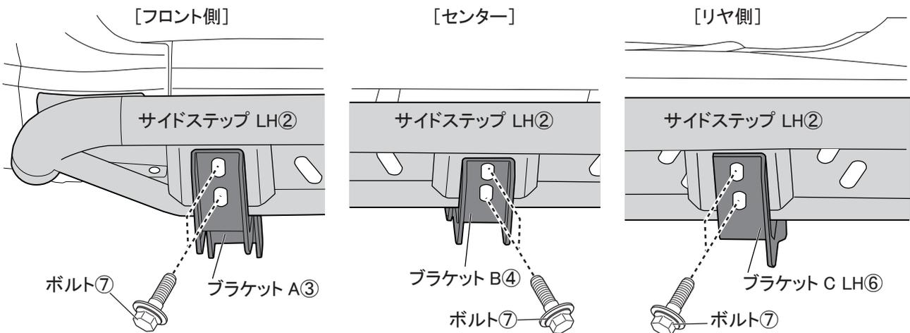
△注意：取付けの際にインパクトレンチは絶対に使用しないでください。製品が破損する場合があります。また仮締めの際は、位置調整ができる程度の締付けを行なってください。
