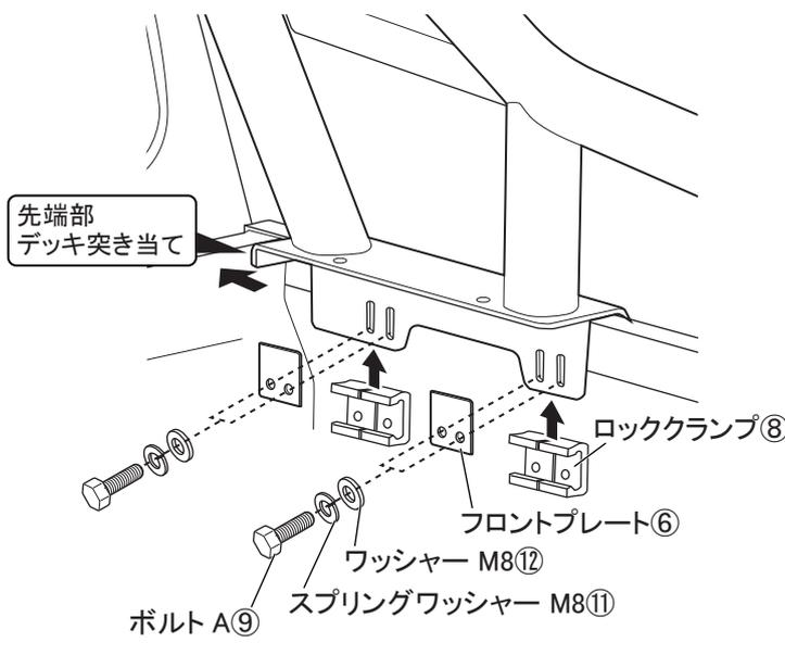
2. 図3のようにフロントプレート⑥、ロッククランプ⑧、ボルト A⑨、スプリングワッシャー M8⑪、ワッシャー M8⑫を使用して仮締めする。(左右各4箇所)
