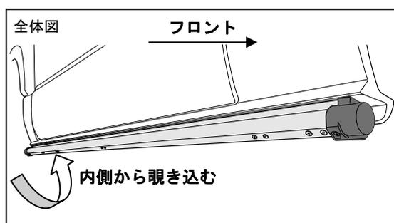
3. 図7のようにブラケットC⑤を取付け、上側のグロメット部をタッピングスクリュー⑧、下側をボルトB⑩で仮締めする。
