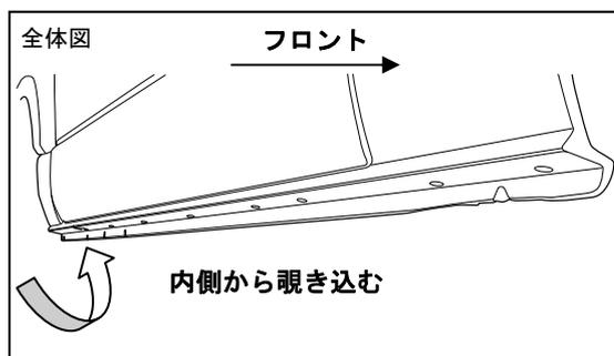
2. 図3の位置に装着されているサイドパネル下部内側の車両グロメットを取外す。
