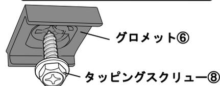
1. 図5を参照しサイドスカートRH①をサイドパネルに取付け、タッピングスクリュー⑧で図示の4箇所を仮締めする。
