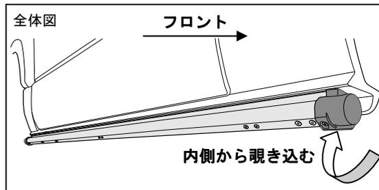
2. 図のようにブラケットA③を置き、上側をボルトA⑨、下側をボルトB⑩で仮締めする。
