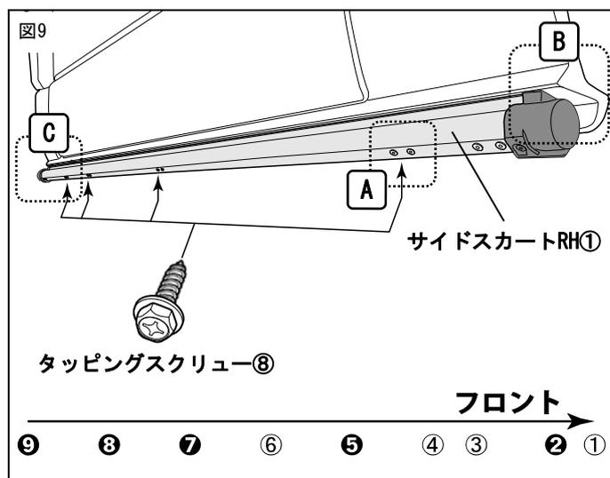
4. サイドスカートRH①の取付け位置を確認し、仮締め部のタッピングスクリー⑧、ボルトA⑨、ボルトB⑩を本締めする。
