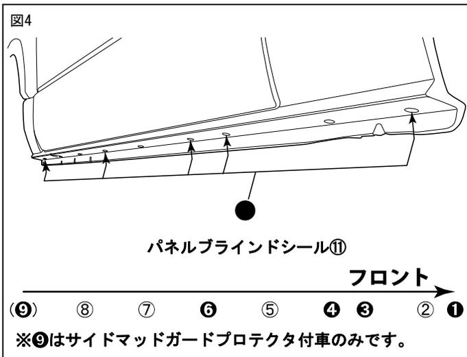
3. 図3を参照し車両グロメットを取外した穴の周りの汚れを拭き取り、IPA又はホワイトガソリンで脱脂をし、パネルブラインドシール⑪を貼付けする。
