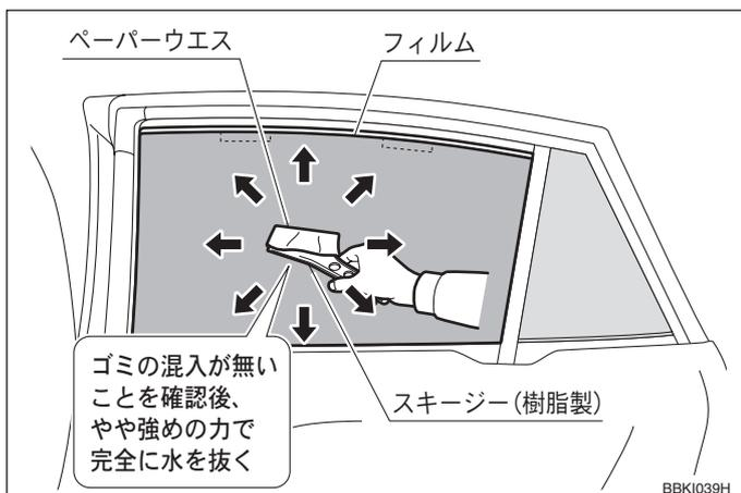
7. ガラス上端からフィルム上端が均等に **3mm** (左図 X-X 断面) の位置になるように取り付ける。
