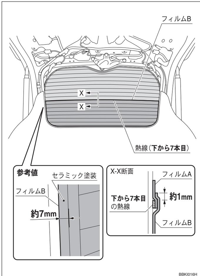
16. 左図 X-X 断面に従い、**下から 7 本目**の熱線上端部からフィルム A と B が**約 1mm** ラップするよう、左右均等に取り付ける。
