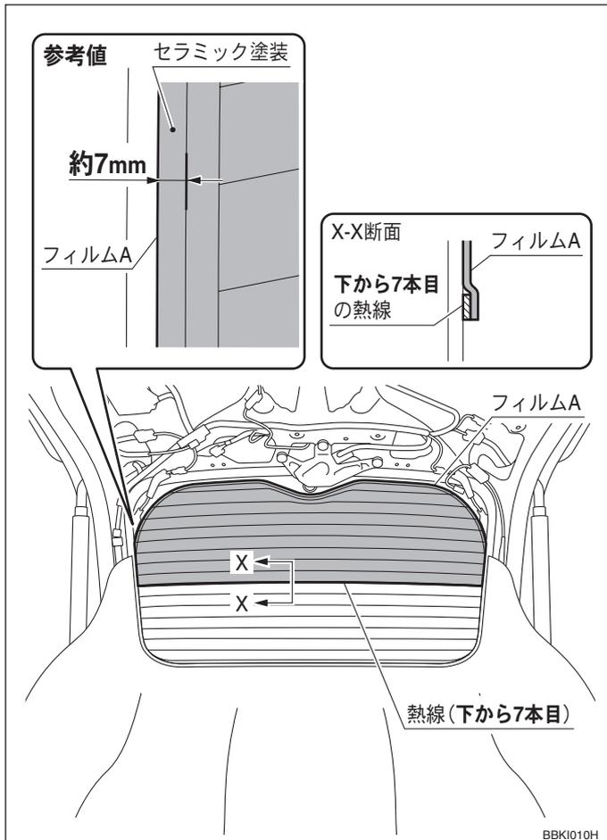
6. 左図 X-X 断面に従い、フィルム A の下端を**下から 7 本目**の熱線下端部に合わせ、バックドアガラスに左右均等に取り付ける。
