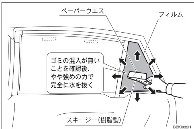
9. ゴミ・ホコリの混入が無いことを確認する。万一混入していた場合は、その部分まで施工液を吹き付けながらフィルムをゆっくり剥がし、異物を除去した後に再度取り付ける。
