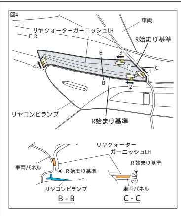
4. 図 4 のようにリヤクォーターガーニッシュ LH を合わせ左右のズレが無いか確認し、 両面テープの離型紙(左右各4箇所)を左 図番号順に剥がしながら貼付け { 49N(5kgf)以上}圧着する。
