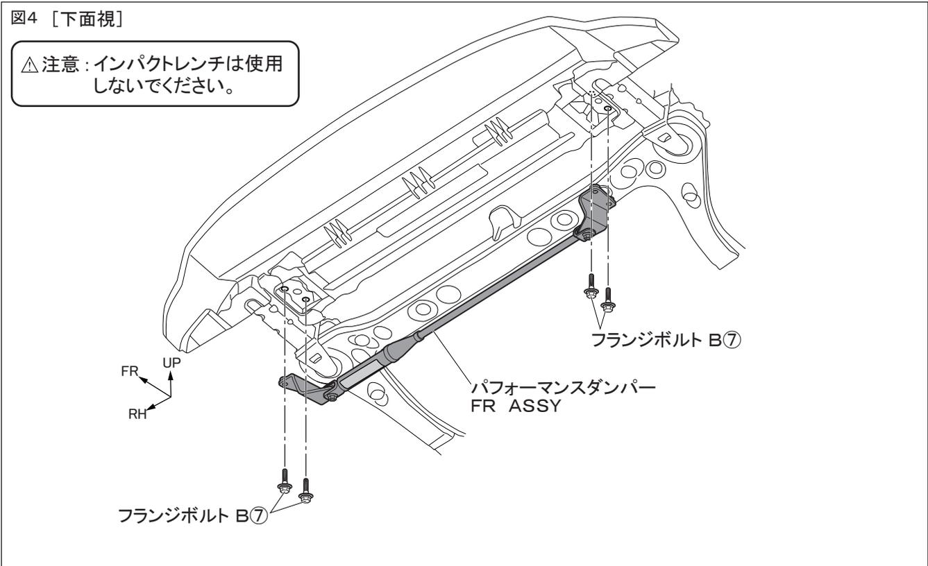
3. 図5のように取付け位置やガタつき等を確認し、仮締めしたフランジボルト A⑥、フランジナット A⑧、フランジボルト B⑦を指定トルクで本締める。
