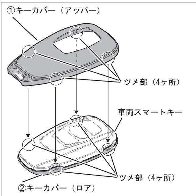
3. ①キーカバー(アッパー)のツメ部(4ヶ所)と②キーカバー(ロア)のツメ部(4ヶ所)の位置が一致している事を確認してから、合わせるように取り付けます。
