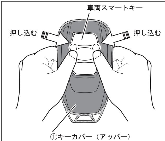
1. 左図を参考に車両スマートキー側の $\cap$ 印を押し込んで、②キーカバー(ロア)から①キーカバー(アッパー)を取り外します。
