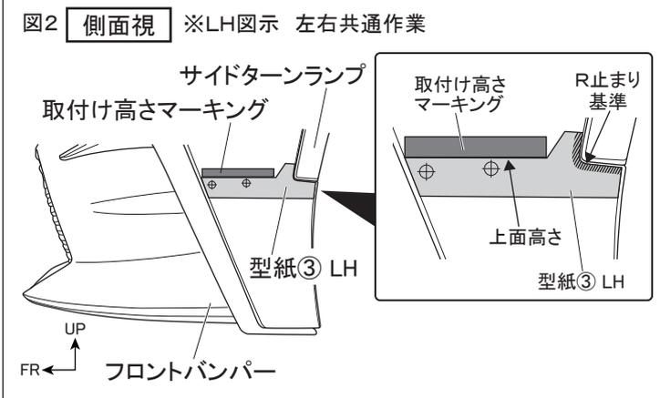
3. 図2のように型紙③をフロントバンパー側面に貼付け、型紙の上面高さに合わせて取付け高さをマスキングテープでマーキングする。(左右各1箇所)
