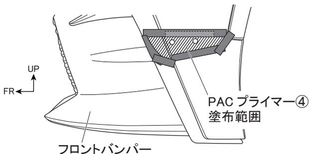
10. 図7のようにカナード①の両面テープ貼付け部(左図斜線部)にPACプライマー④を塗布する。
