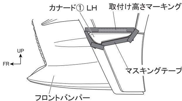
7. 図5のようにカナード①端末に合わせてフロントバンパーにマス킹テープを貼付ける。
