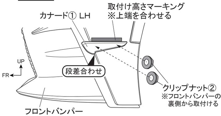
6. 図4のようにフロントバンパー側面の取付け高さマーキングに合わせてカナード①をあて、フロントバンパー裏側からクリップナット②で仮締めする。(左右各2箇所)
