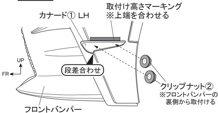
2. 図9のようにフロントバンパー側面の取付け高さマーキングに合わせてカナード①をあて、フロントバンパー裏側からクリップナット②で仮締めする。(左右各2箇所)
