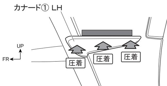
3. 図10のように取付け位置を確認して両面テープ貼付け部を圧着する。(左右各3箇所)
