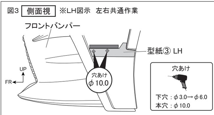
4. 図3のように型紙③の穴あけ位置に合わせて下穴φ3.0→φ6.0の順であけ、φ10.0の本穴をあける。(左右各2箇所)
