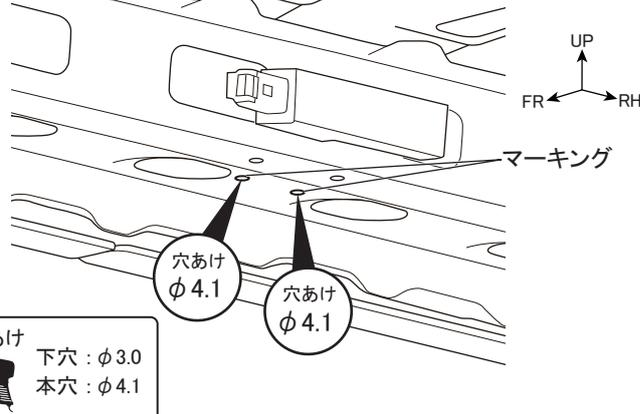
14. 図7のようにマーキングに合わせて下穴 $\phi 3.0$ であけ、 $\phi 4.1$ の本穴をあける。（2箇所）
