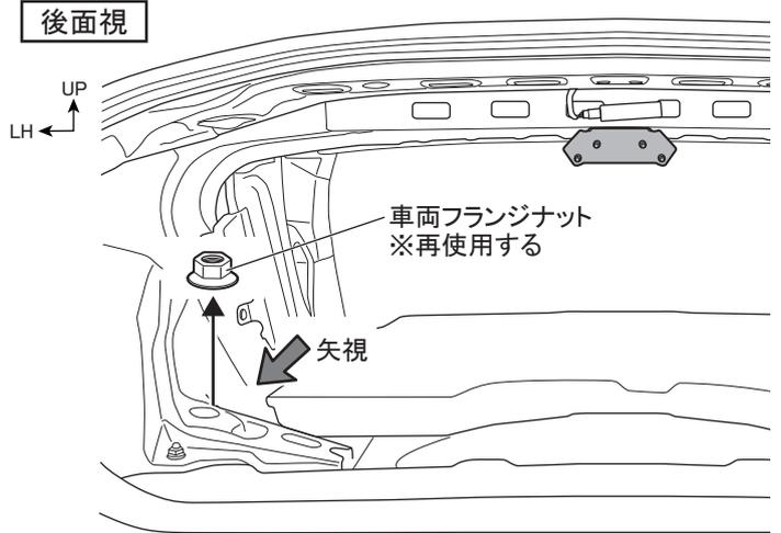
👉 アドバイス：取り外した車両フランジナットは再使用しますので傷つきや紛失がないよう十分に注意して保管してください。
