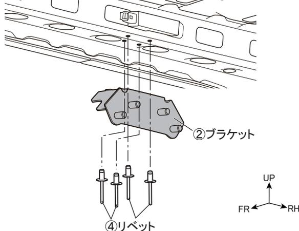
1. 図8のように $\phi 4.1$  加工穴（4箇所）に合わせて②ブラケットをあて、取付位置を確認して④リベットを取り付け、固定する。（4箇所）
