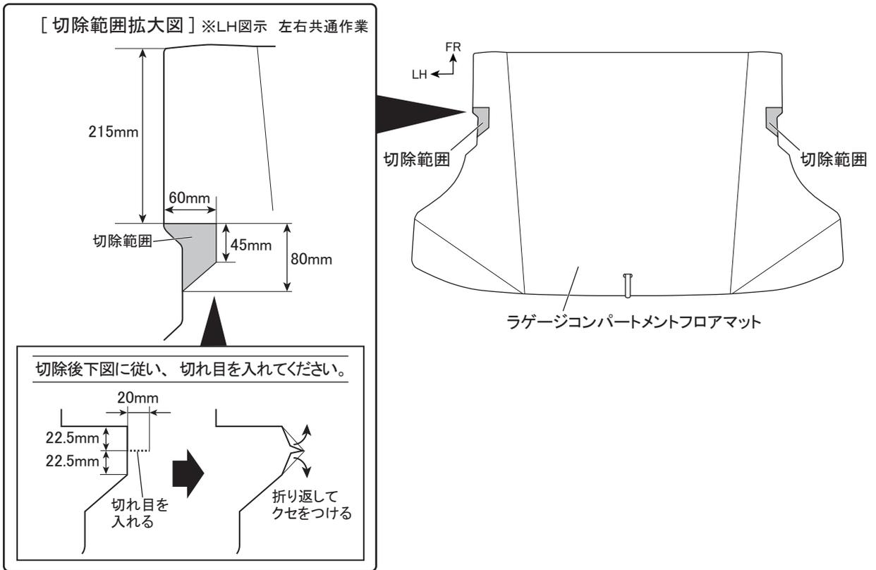
3. 切除部周囲のバリを除去し、ラゲージコンパートメントフロアマットを車両に復元する。
