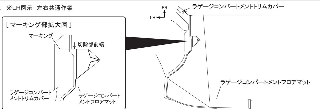
5. 該当車両の修理書に従い、ラゲージコンパートメントフロアマットおよびラゲージコンパートメントトリムカバーを取り外す。
