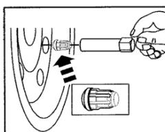
専用アダプターを使用し、座面まで手締めを行う。
