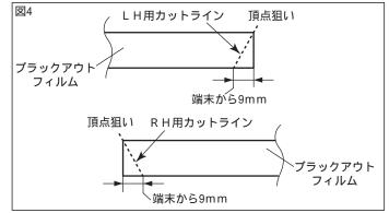
▼ アドバイス: ブラックアウトフィルムは2枚同梱されています。 R H用、L H用として1枚ずつ使用します。
