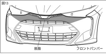
15.図13のようにフロントバンパーのフロント バンパーガーニッシュ 取付け部の汚れを 取除き、脱脂する。
