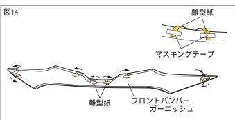
16.図14のようにフロントバンパーガーニッシュ の離型紙を中央から外側に約30mm剥がし、マスキングテープ等で表側に貼付ける。 (左右各4箇所)
