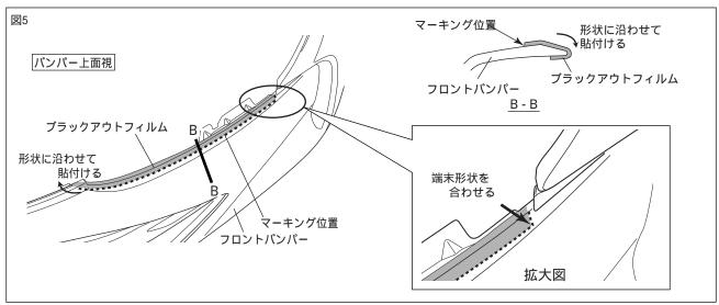
5.作業1でマーキングした形状に、作業4でカットしたブックアウトフィルム を端末形状を合わせ、マーキング位置に沿って貼付ける。 (R/L各1箇所)
