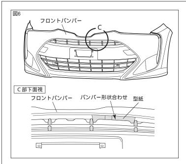
6.図6のように、フロントバンパーのC部下 面形状に合わせて型紙 を貼り付ける。 (1箇所)
