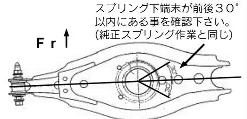
スプリング下端末が前後30°以内にある事を確認下さい。(純正スプリング作業と同じ)
