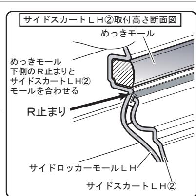
2. 図12のようにサイドスカート①を 1. で貼付けた高さ位置マスキングテープに合わせ、タッピング スクリュー③、⑤で仮締めし、取付け高さを合わせをガムテープ等で仮固定する。(左右各 2箇所)
