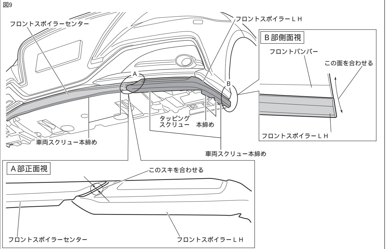
5. 図9のようにフロントスポイラーセンター とフロントスポイラー-LH のA部のスキが左右で同様になるよう調整しフロントスポイラーセンター を本締めする。 ・車両スクリーン（左右各2箇所）
