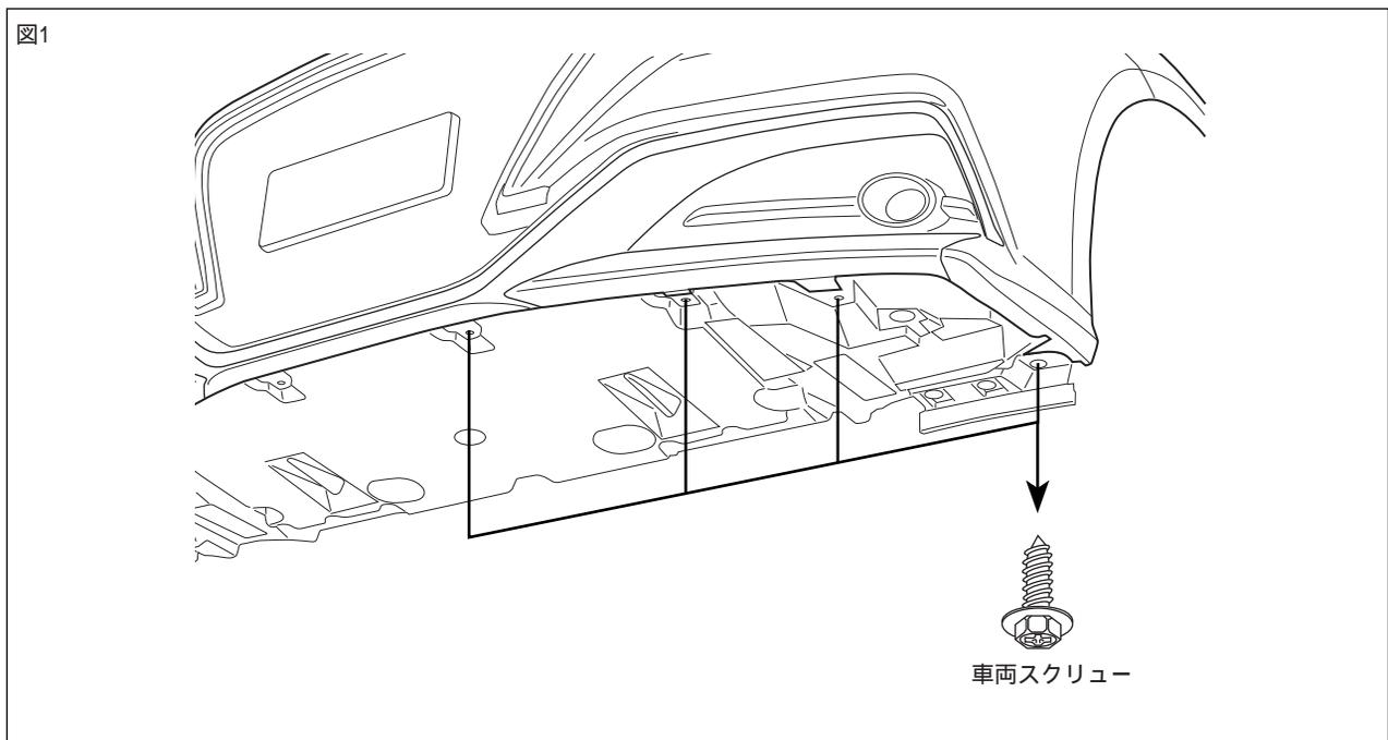
1. 図1のようにフロントバンパー下面部の車両スクリューを取外す。 (左右各4箇所)
