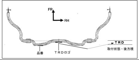
・左図のように、装着状態で車両後方より TRDロゴが正読できるように取付けて 下さい。
