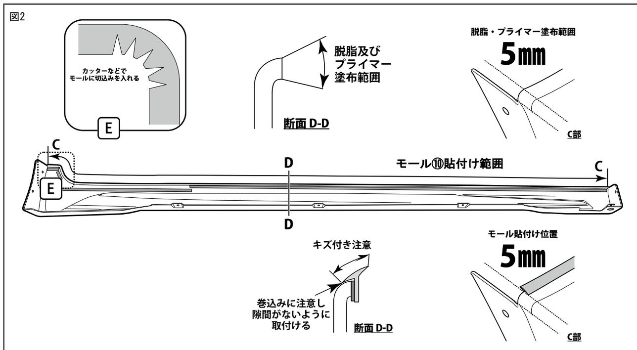
2. モールド貼付け部の汚れを取除きIPA又はホワイトガソリンで一方向に拭いて脱脂し、プライマー⑪を塗布する。
