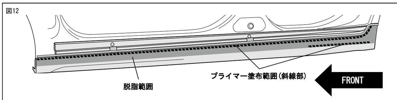
14. サイドスカートを一旦取外し図に従いサイドスカート取付け部の汚れを取除き、IPA又はホワイトガソリンで一方方向に拭いて脱脂した後、斜線部にプライマー⑥を塗布する。
