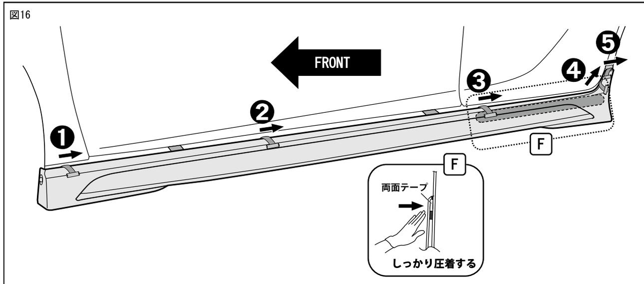
20. 図のようにサイドスカート成型紙⑦及び後部マスキングテープの高さに合わせ上下左右のバランス、隙、ズレが無いことを確認し、図の順に両面テープ離型フィルムを引抜き圧着する。
