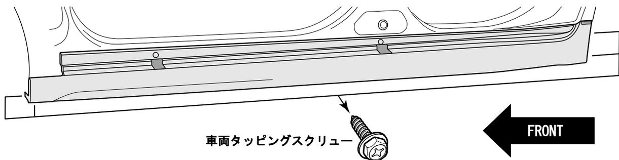
12. 図を参照し車両タッピングスクリューを外す(左右4箇所)
