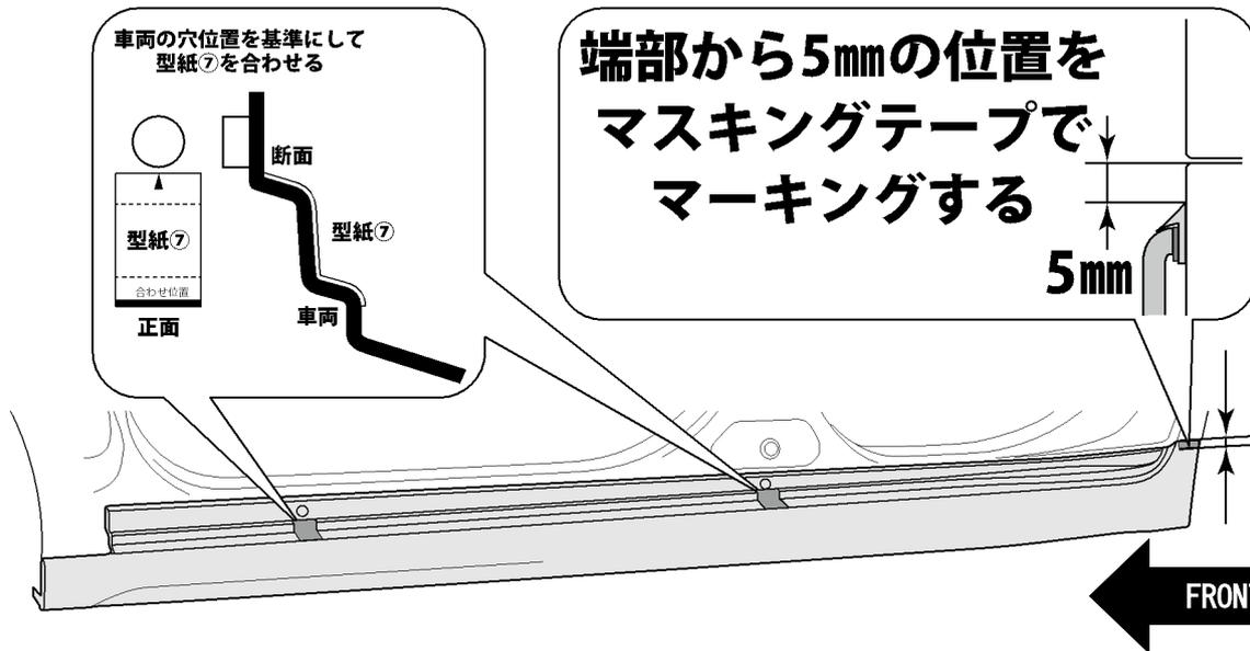
11. 図を参照しサイドロッカーモールに型紙⑦貼付け、後部の高さ基準位置をマスキングテープでマーキングする。
