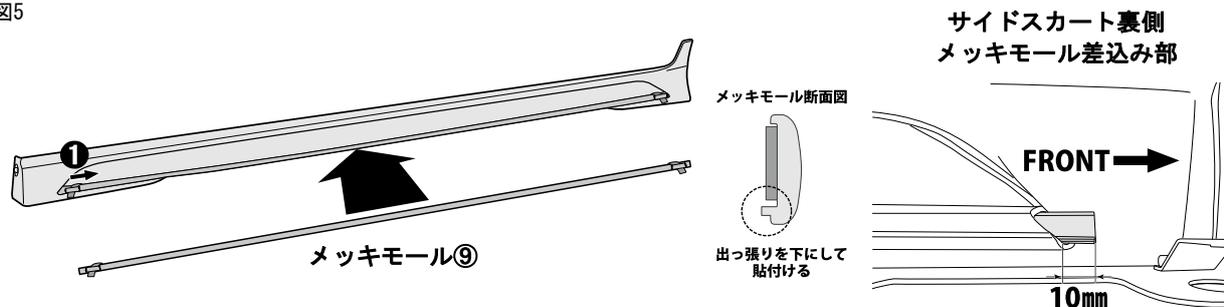
7. サイドスカートにメッキモール⑨の離型フィルムを剥がしながら貼付け確実に圧着する。
