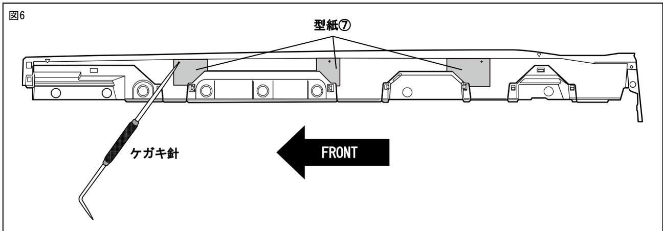
8. 図のように型紙⑦をサイドロッカーモールの形状に合わせて貼付け、マーキング後、型紙を剥がす。
