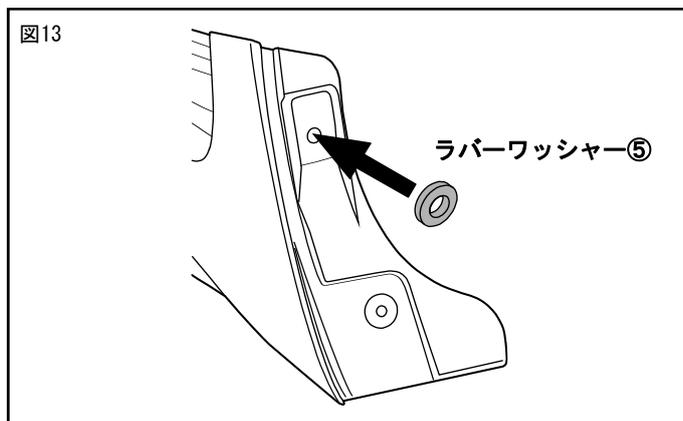
15. 車両リヤ側タイヤハウス内のインナーカバーをめくり、ラバーワッシャー⑤を貼付ける。(左右1箇所)
