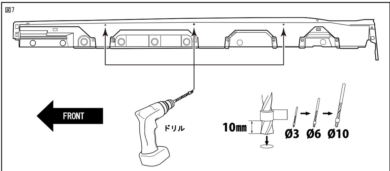
9. 図を参照しØ3、Ø6、Ø10のドリル先端にストッパーとして10mmの位置にガムテープを巻付け、Ø3とØ6のドリルで下穴、最後にØ10のドリルで本穴をあけ、バリを取除く。(左右各3箇所)
