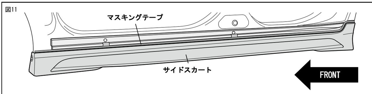
13. 図のようにサイドスカートを車両にあてがい、取付け位置をマスキングテープで養生する。
