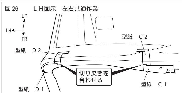
15. 図 26 のように型紙 C1、D1 の上部切り欠きに合わせて型紙 C2、D2 を貼り付ける。
