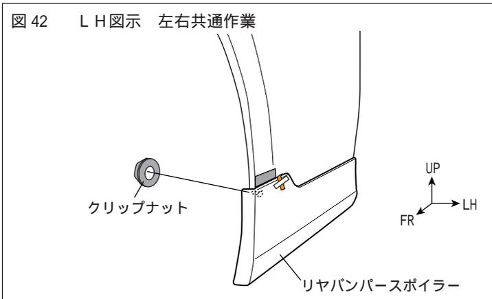
3. 図42のようにリヤバンパースポイラー 側面をクリップナット で仮締めする。
