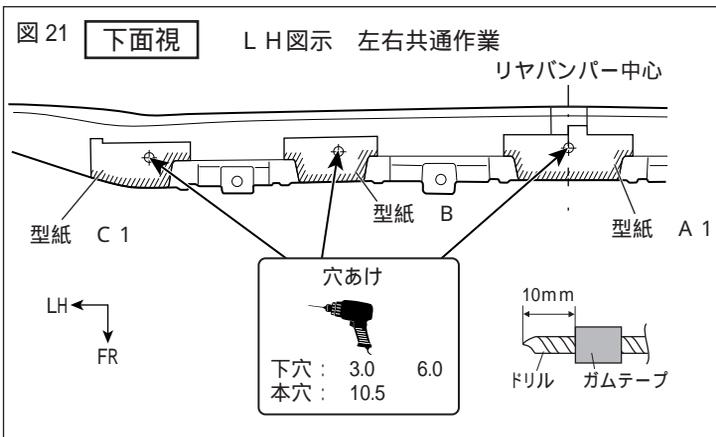
5. 図 21 のようにドリルにストッパーになるようにガムテープを巻き、型紙 A 1、B、C 1 の穴あけ位置に合わせて下穴を 3.0 6.0 であけ、10.5 の本穴をあける。(全 5 箇所)
