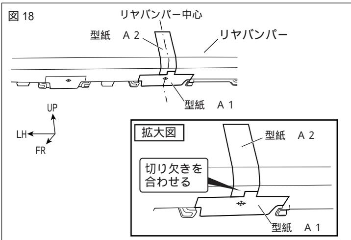
2. 図 18 のようにリヤバンパー中央の型紙 A 1 上部切り欠きに合わせて型紙 A 2 を貼り付ける。
