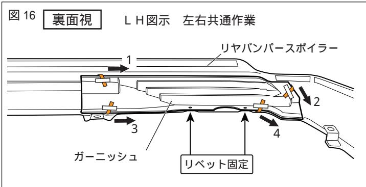
5. 図 16 のように取付け位置及び各部の相沿いを確認して両面テープの離型紙を矢印の方向へ番号順に剥がしながら貼付け圧着する。
