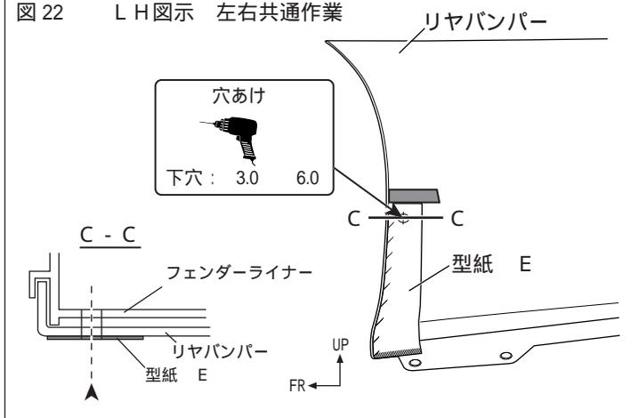
7. 図 22 のように型紙 E の穴あけ位置に合わせて下穴を 3.0 6.0 であける。その際にフェンダーライナーを貫通させる。(左右各 1箇所)
