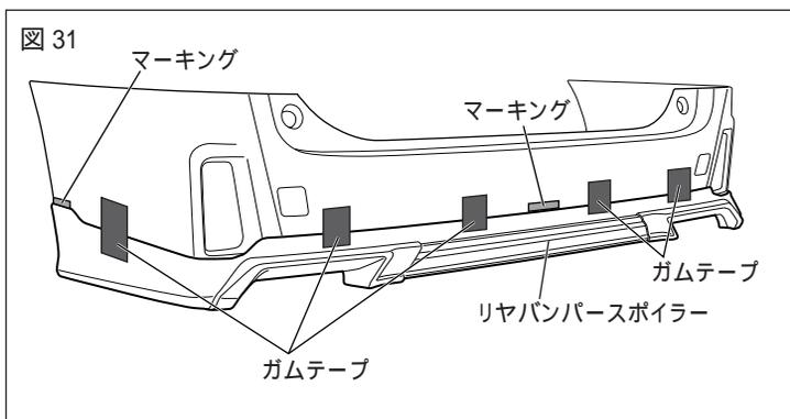
22. 図 31 のようにリアバンパーにリアバンパースポイラー をかぶせ、リアバンパースポイラー のモール上端を取り付け高さマーキングに合わせてガムテープ等で仮固定する。
