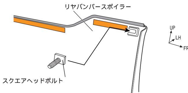
28. 図 35 のようにリヤバンパースポイラーにスクエアヘッドボルトを取り付ける。(左右各1箇所)
