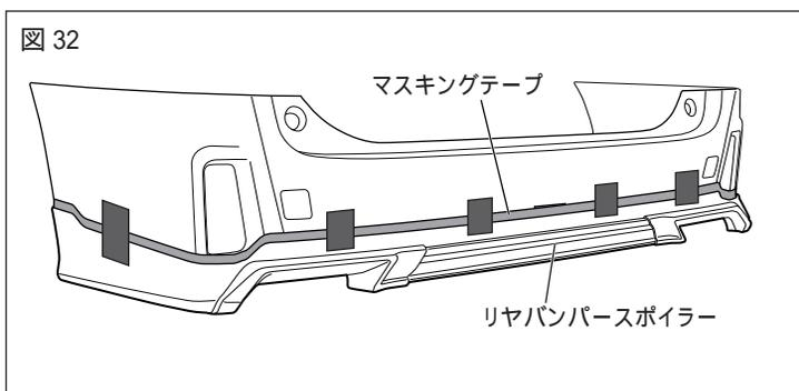
23. 図 32 のようにリアバンパースポイラー のモール上端に合わせてマスキング作業を行う。
