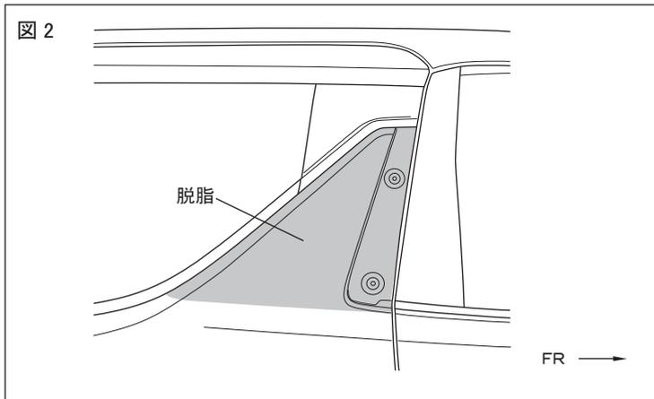
2. 図2のようにBピラーガーニッシュ取付部を清掃し汚れを完全に取り除き、PACクリーナー④で一方向に拭いて脱脂をする。
