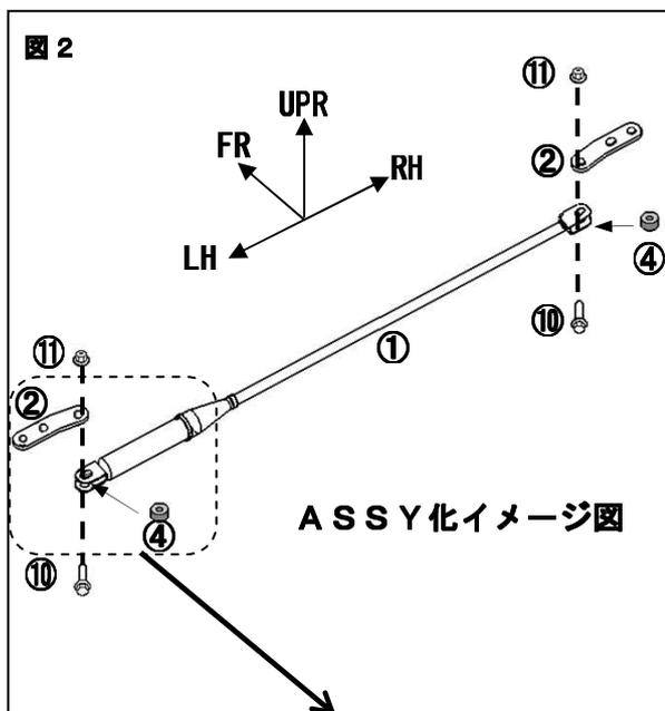
4. 図2のように、FRパフォーマンスダンパー①にFRダンパーブラケット②・スペーサー④をセットし、フランジボルト⑩・フランジナット⑪を使用して仮組みを行い、ASSEMBLY化する。
