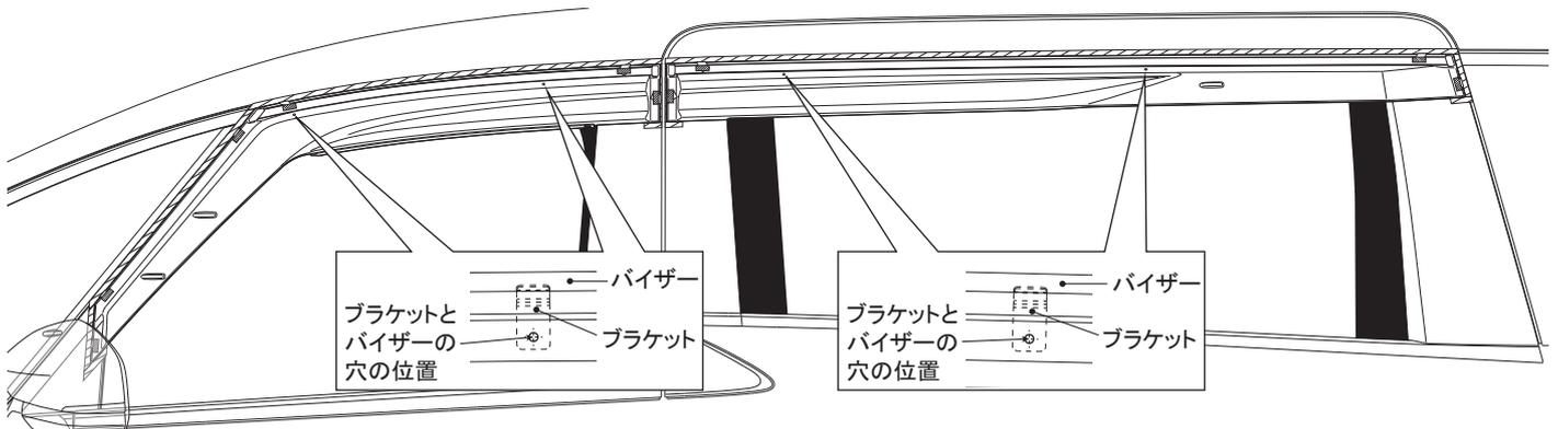
△注意：ブラケットピンは一度使用すると性能が著しく低下するため、ブラケット位置確認の際、ブラケットピンは挿入しないでください。
