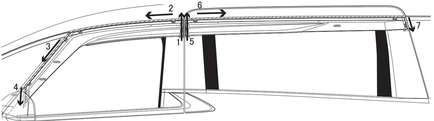
👉 **アドバイス** 両面テープの接着力は安定するまで3～5時間程度必要です。製品の取り付け後は、最低3時間程度、強い振動や風圧（車両の移動を含む）が、掛からないようにオープンタイム（静止時間）お取りください。
