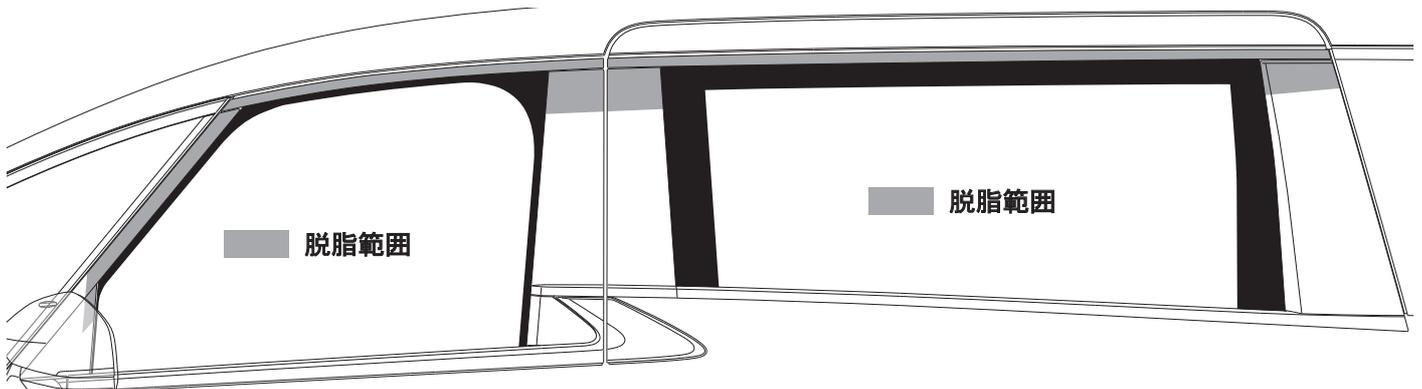
△注意：脱脂を確実に行わないと、浮き、剥がれ、脱落の原因となります。
