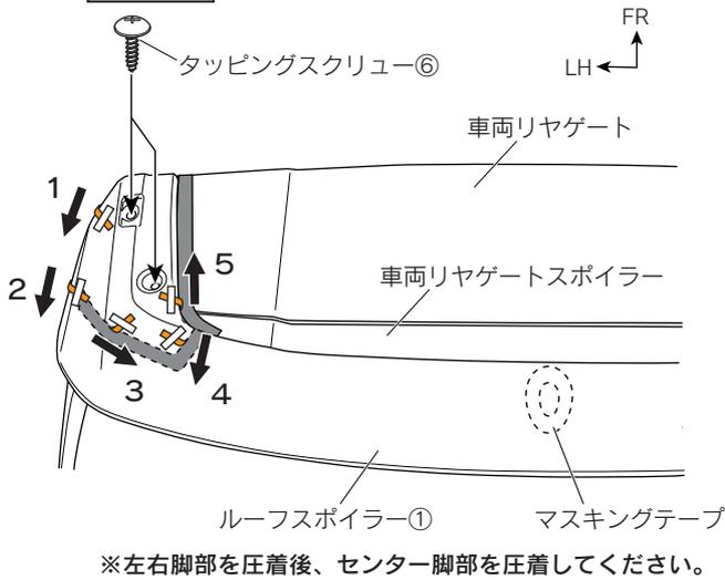
図 12 上面視 ※LH図示 左右共通作業
