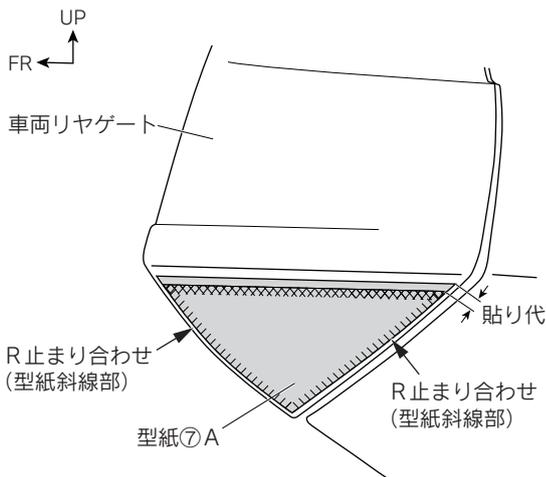
車両リヤゲートスポイラー側面に型紙⑦Aを貼付ける。
