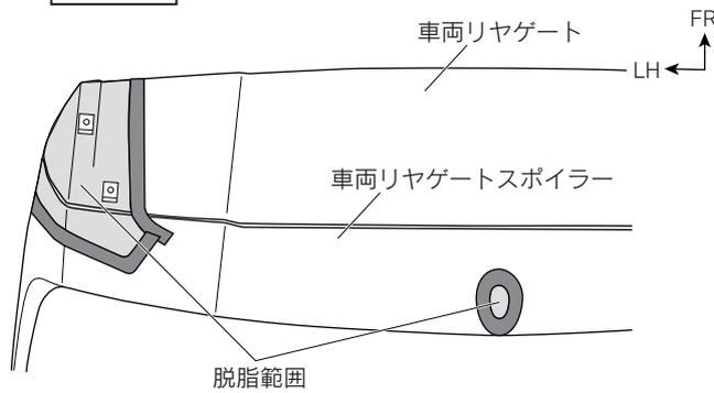
8. 図8のように車両リヤゲート及び車両リヤゲートスポイラーの両面テープ貼付け部の汚れを取除き、IPA又はホワイトガソリンで一方方向に拭いて脱脂する。
