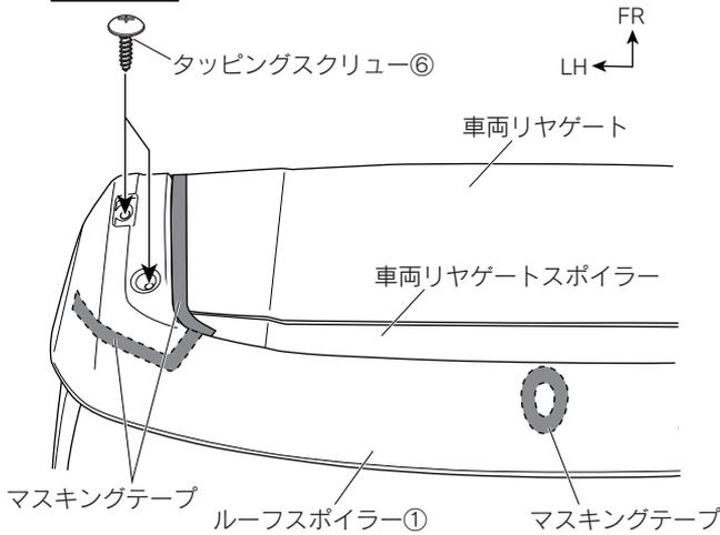
6. 図7のように車両にルーフスポイラー①をあて、タッピングスクリュー⑥を仮締めし、取付け位置及び各部の隙を確認してルーフスポイラー①脚部端末に合わせ、車両リヤゲート及び車両リヤゲートスポイラーにマスキングテープを貼付ける。
