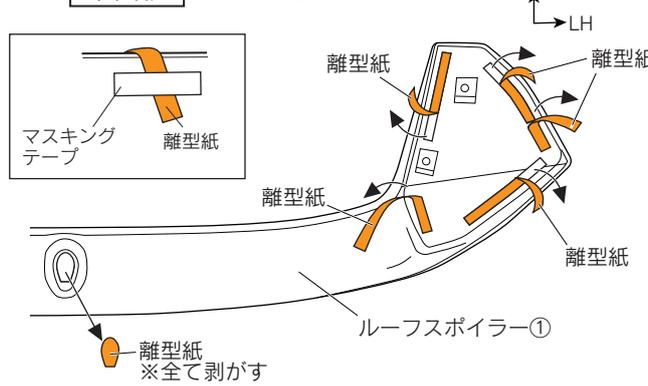
10. 図10のようにルーフスポイラー①の両面テープの離型紙を矢印の方向に約30mm剥がしてマスキングテープ等で表側に貼付ける。
