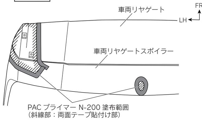
9. 図9のように車両リヤゲート及び車両リヤゲートスポイラーの両面テープ貼付け部の両面テープ貼付け部（左図斜線部）にPACプライマー N-200⑧を塗布する。
