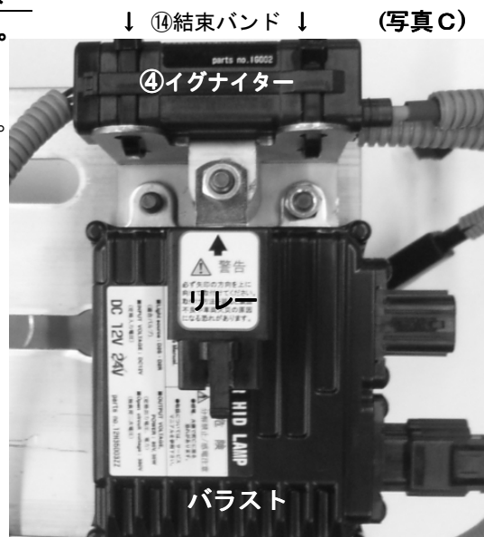
運転席側リーンホースメント裏面取付け状態
