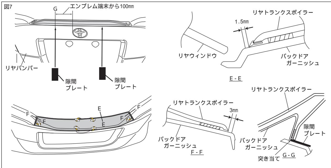
3. 図7のようにリヤトランクスポイラーが車両に平行で左右中心に来るように位置出ししながら、バックドアガーニッシュに合わせる。隙間プレートを図の寸法の位置に差し込む。
