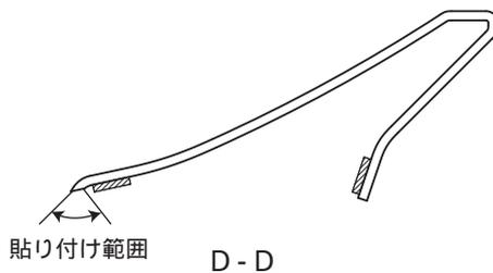
2. 図4のようにリアトランクスポイラーに、モールの離型紙を剥がしながら貼付け、確実に圧着する。
