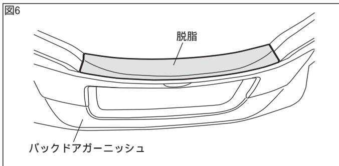
2. 図6のようにバックドアガーニッシュの取付部の汚れを取り除き、PACクリーナーで一方向にふいて脱脂する。
