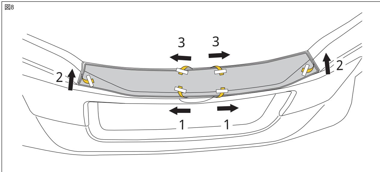
4. 図8のようにリアトランクスポイラー とバックドアガーニッシュにズレが無いが確認し、両面テープの離型紙（左右各3箇所）を番号順に剥がしながら貼付け圧着する。 { 49 N ( 5 k g f ) 以上 }
