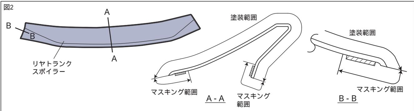
1. 図2のようにリヤトランクスポイラー をボディ色で塗装する。
