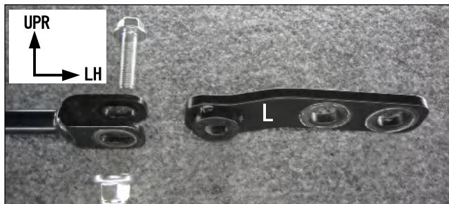
4. フロント パフォーマンスダンパー（ロッド側）を専用 ボルト（M10）及びナットで、フロント ダンパー ブラケット LHに仮付けする。
