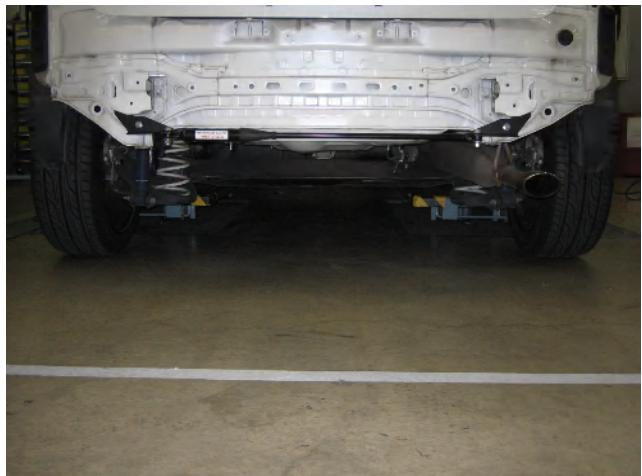
6. タイヤを接地状態にして、仮付けしていたリヤ パフォーマンスダンパー ボルト 2 本を締め付ける。
